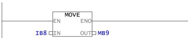
Réseau : 4 Test des roues codeuses poids forts
